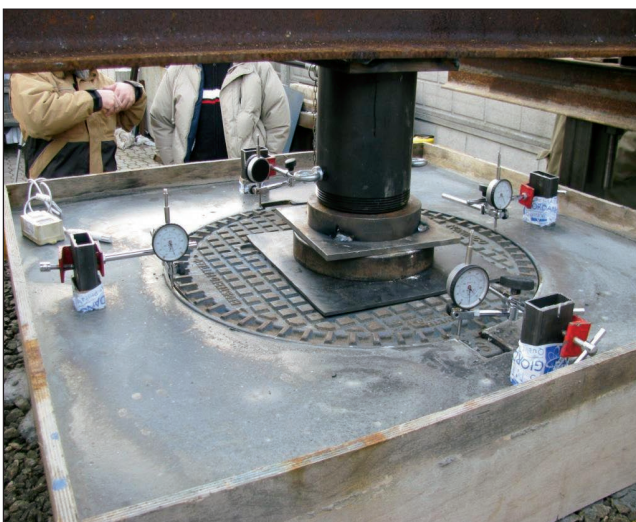
Figura 8: Comparatori centesimali disposti lungo il bordo del colletto cilindrico del chiusino
