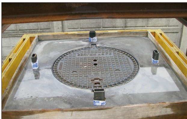
Figura 9. Campione al termine della prova di carico statico fino a 650 kN
