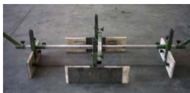
Sistema di contenimento regolabile per messa in quota di chiusini rettangolari
