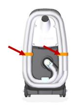
• Il generatore di fumo può essere trascinato sulle ruote o sollevato. Quando si solleva l'apparecchio utilizzare i manici nella parte superiore e inferiore.
