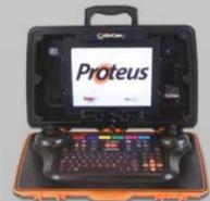
L'unità di controllo **All in One** di Proteus, ultraleggera ed a bassissimo consumo, è integrata con computer e monitor 10" ad alta visibilità. Visualizza, registra ed annota ogni osservazione sincronizzandola con il contametri.
