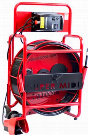
Il Super Midi Miller è progettato per la pulizia, la scarificazione, la rimozione di radici, e la riapertura degli allacci in tubazioni da DN70-150. Ha una portata di 20 m che può essere incrementata di ulteriori 10 m, con un'estensione del cavo. Può anche essere accoppiato alla Pompa Picote Maxi Coating per rivestire tubazioni tra DN70-200
