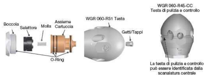
Figura 27 Switcher vista esplosa
