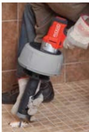
Il cavo da  $\frac{3}{8}$ " (10 mm) nel Modello K-45AF-5 estende la capacità della stasatrice a condutture di scarico fino a  $2\frac{1}{2}$ " (75 mm).
