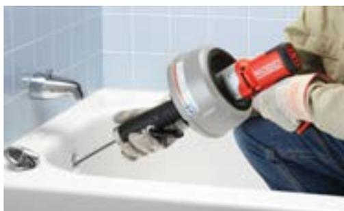
La K-45AF disostruisce rapidamente le condutture intasate. Manda avanti e indietro il cavo senza invertire la rotazione del motore.
