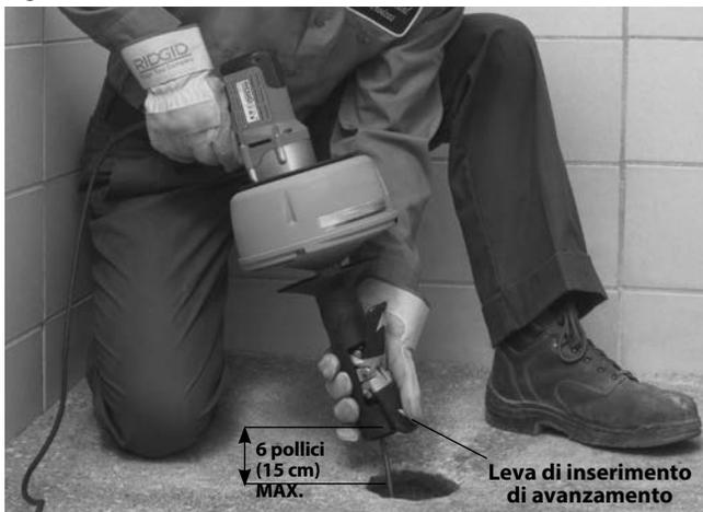
**Figura 10 – Inserimento del cavo in modalità AUTOFEED**
