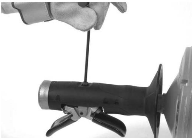
**Figura 12A – Rimozione della vite AUTOFEED**
