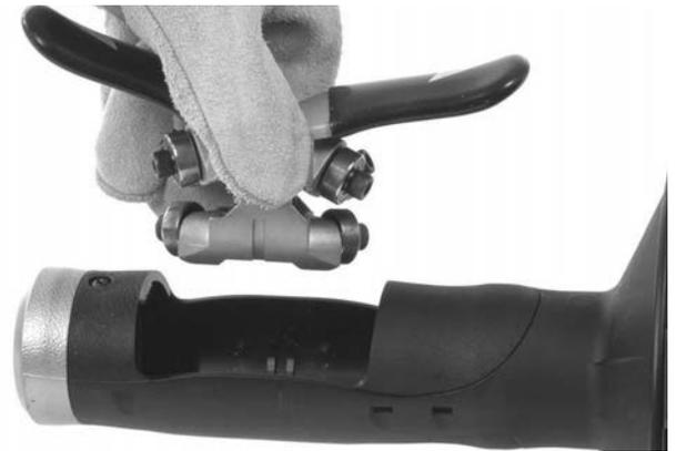
**Figura 12B – Rimozione del meccanismo AUTOFEED dall'alloggiamento**
