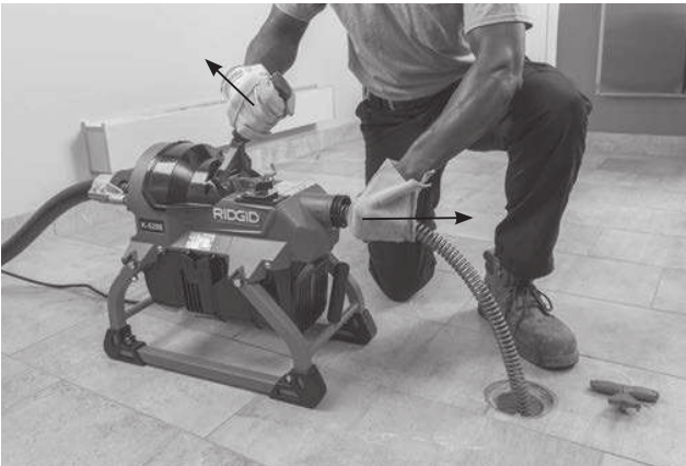
Figura 11B – Frizione rilasciata, Cavo non ruotante, Estrazione del cavo dalla macchina
