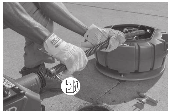
Figura 7 – Inserimento del cavo nel lato anteriore della macchina
