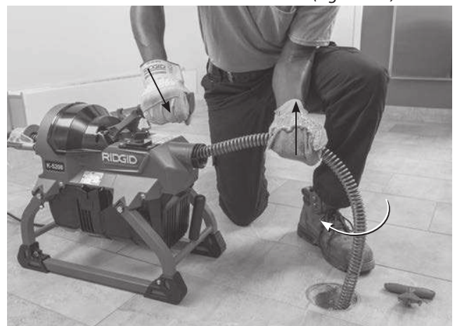
Figura 14A – Frizione innestata, Cavo ruotante, Estrazione del cavo dallo scarico
