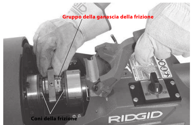
Figura 18 – Installazione della ganascia della frizione
