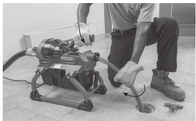
Figura 11A – Frizione innestata, Cavo ruotante, Inserimento del cavo nello scarico
