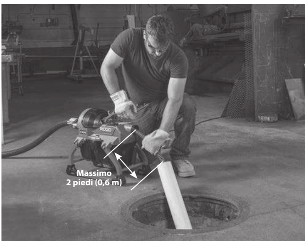
Figura 5 – Esempio di estensione dello scarico fino ad un massimo di 2 piedi (0,6 m) dall'Uscita del cavo della macchina
