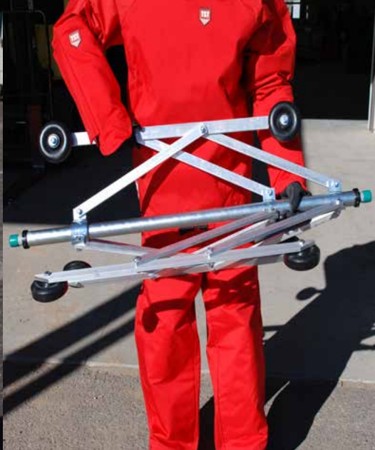
Le guide di centraggio prevengono l'inversione dell'ugello
