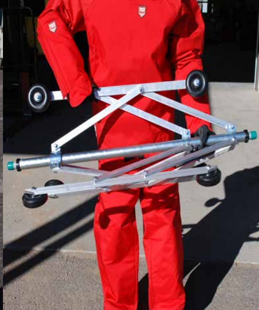
Le guide di centraggio prevengono l'inversione dell'ugello
