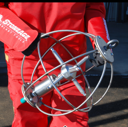
Guide a sfera ideali per tubazioni con curve
