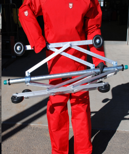
Le guide di centraggio prevengono l'inversione dell'ugello
