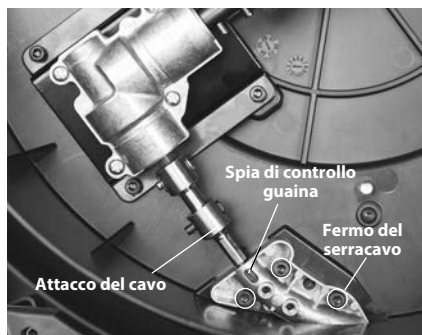
Figura 16 – Sostituzione del Gruppo del cavo
