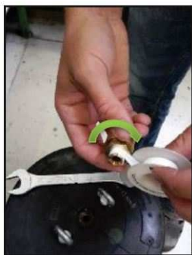
Figura 11: Nastro di tenuta in teflon avvolto sul filetto del giunto di collegamento
