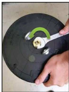
Figura 9: Rimozione del giunto di collegamento
