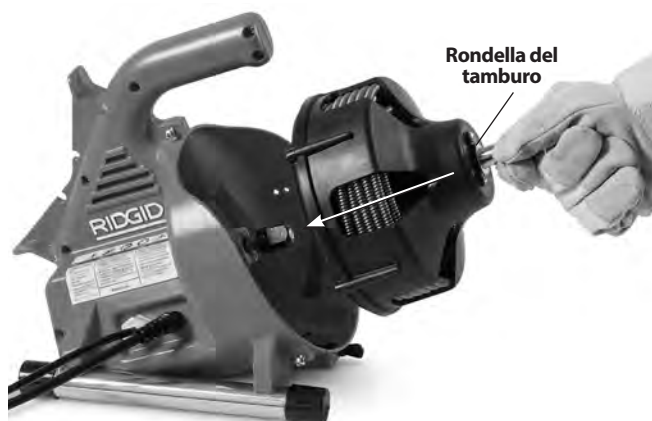
Figura 16 – Inserimento del Tamburo nella Macchina
