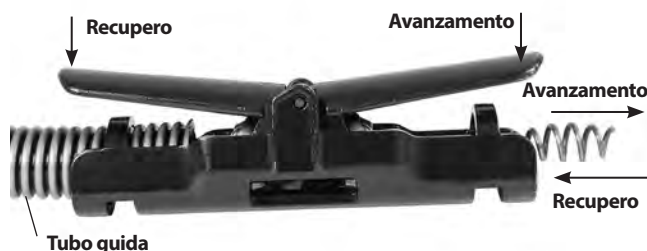
Figura 9 – Avanzamento/Ritrazione della Leva di inserimento
