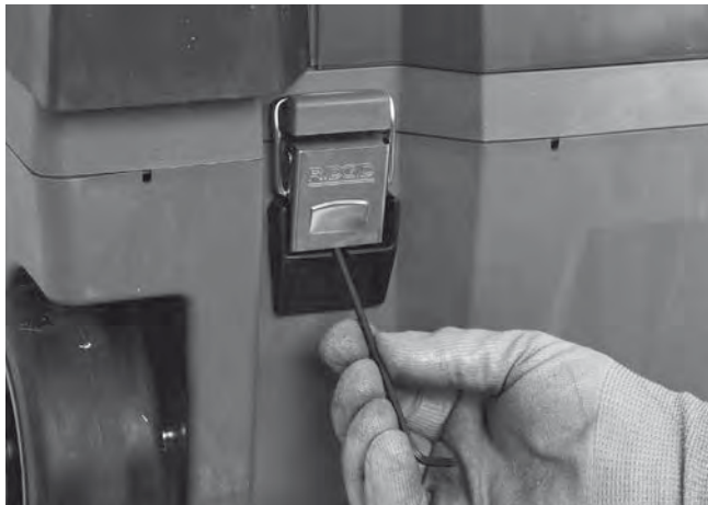
Figura 19 – Aprire il fermo sotto la maniglia di trasporto (usare la chiave esagonale)
